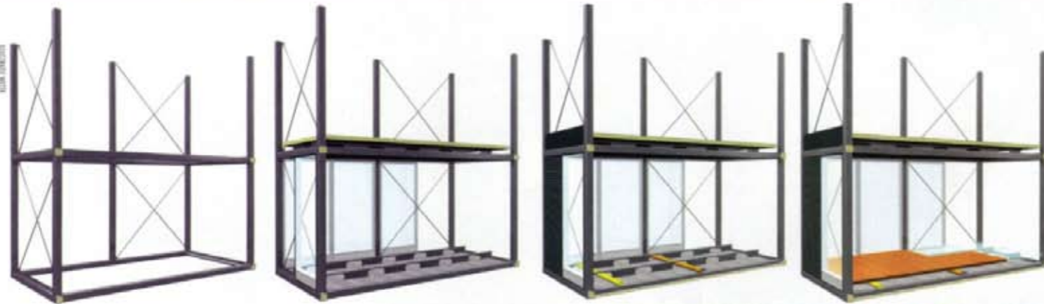
Opbouw van een woonmodule volgens de uitgangspunten van slim bouwen met een dunne leidingvloer, een skeletconstructie en lichtgewicht wanden.
