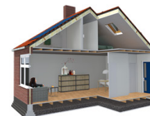
Eenlaags met kap en houten vloer
