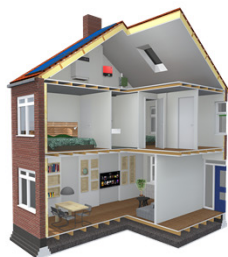
Tweelaags met kap en houten vloer
