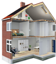
Tweelaags met kap en betonvloer
